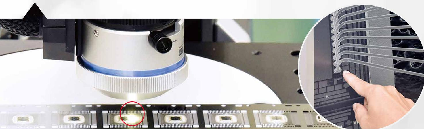
▲超音波による「極微細線の接合技術」は、半導体製造のICチップ電極の配線工程にも使われています。
